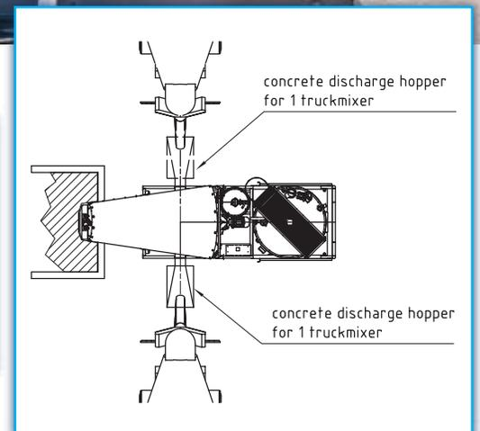
BETONWASH es la solución definitiva para recuperar el concreto sobrante y el agua sucia del lavado de bombas, mezcladoras, hormigoneras, etc.
